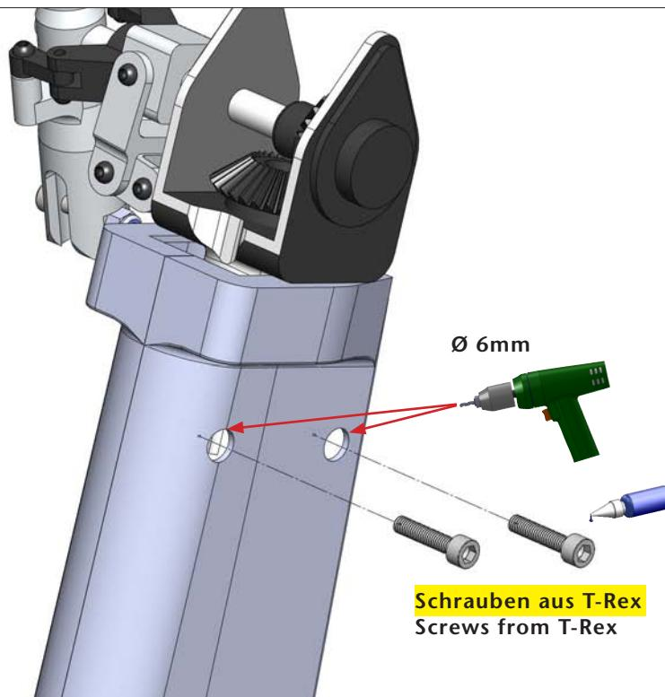
**Montage Steuerhebel und Schubstange**
